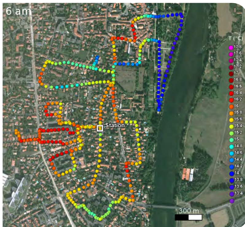
Figure 9: Température de l'air dans un quartier périurbain (Blagnac) à partir des relevés par vélo instrumenté Source: A. Lemonsu (CNRS/CNRM)
